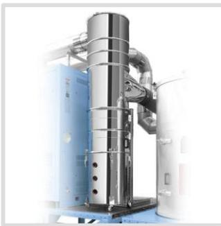
Sistema de filtración adecuado para la separación de micropartículas hasta 10 micras por efecto centrífugo. Adecuado para el tratamiento de aire caliente de retorno a los procesos de secado. Instalado para proteger los filtros, aumenta su autonomía, reduciendo las operaciones de limpieza y paradas de la máquina
