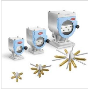
Han sido diseñados para el empleo en el interior de las tolvas, de los receptores y contenedores. Potentes magnetos siguen el flujo de la caída del gránulo garantizando la máxima eficiencia de captura de pequeñas partes metálicas. La serie de estrella STS es apta para ser aplicada en las tolvas. La serie STC, en forma de cajón, puede ser instalada en columna.
